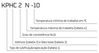
Figura 1 - Exemplo de classificação DIN 51502/51825
